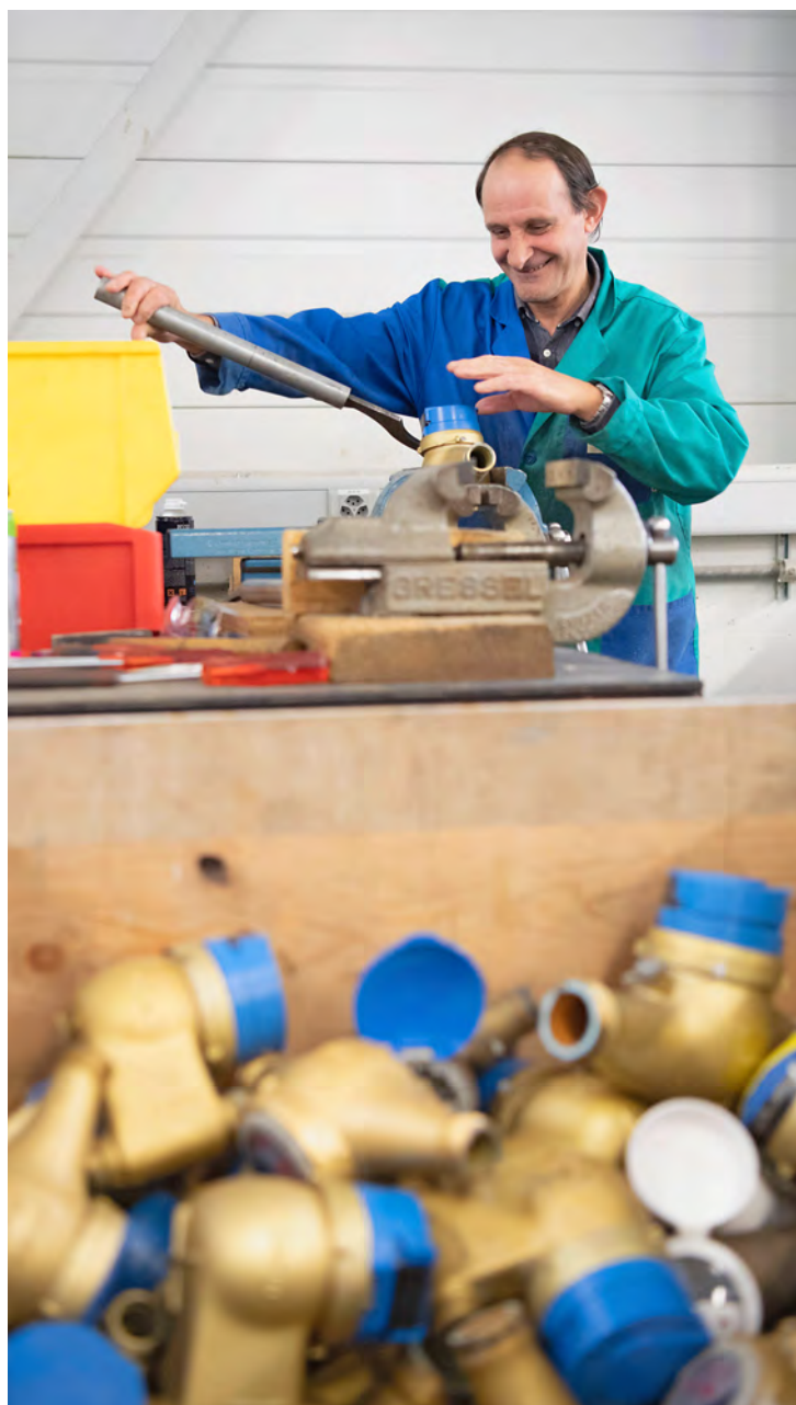
Andreas Arnold zerlegt Wasserzähler in ihre Einzelteile.
